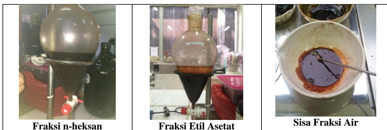
Gambar 3. Fraksinasi Ekstrak Menggunakan n -heksan, Etil Asetat, dan Air
