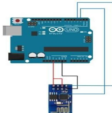
Rangkaian ESP8266 dengan Arduino seperti terlihat pada gambar 9 diatas ini dimana VCC pada ESP8266 dihubungkan dengan pin 3,3V pada mikrokontroler arduino. Ini dikarenakan rangkaian didalam *board* ESP8266 bekerja dikisaran tegangan 3,3 Vdc.
