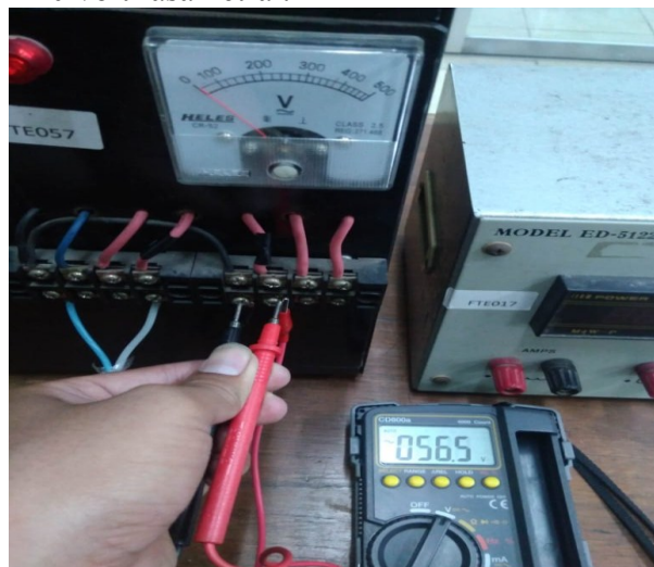
Gambar 12. Tegangan fasa netral dari jaringan PLN
