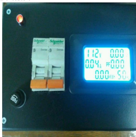
Gambar 10. Tegangan antar fasa dari generator satu
