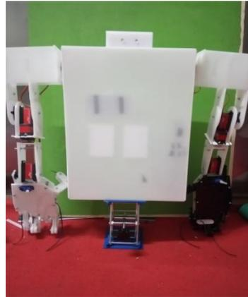
**Gambar 10. Prototype Robot Pemijat Berbasis Arduino**
