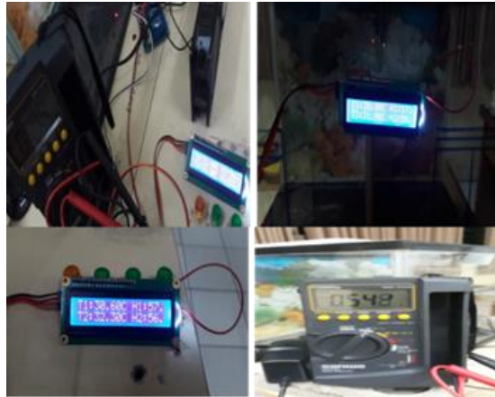
Gambar 7. Pengujian sumber daya listrik pada Sensor DHT11
