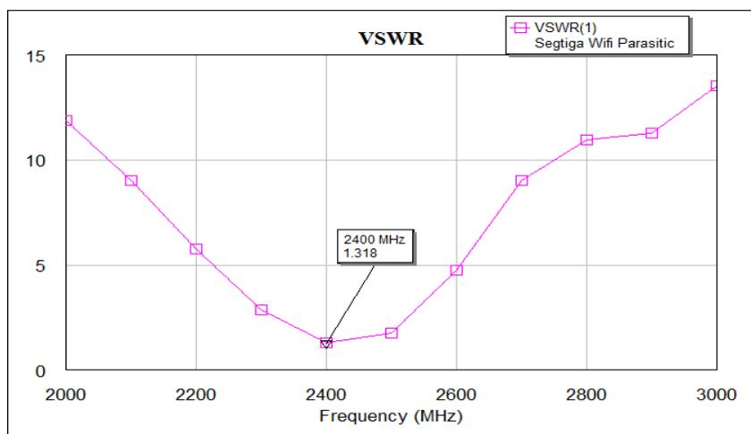
**Gambar 4.8** Nilai *VSWR* antenna dengan beban parasitic
