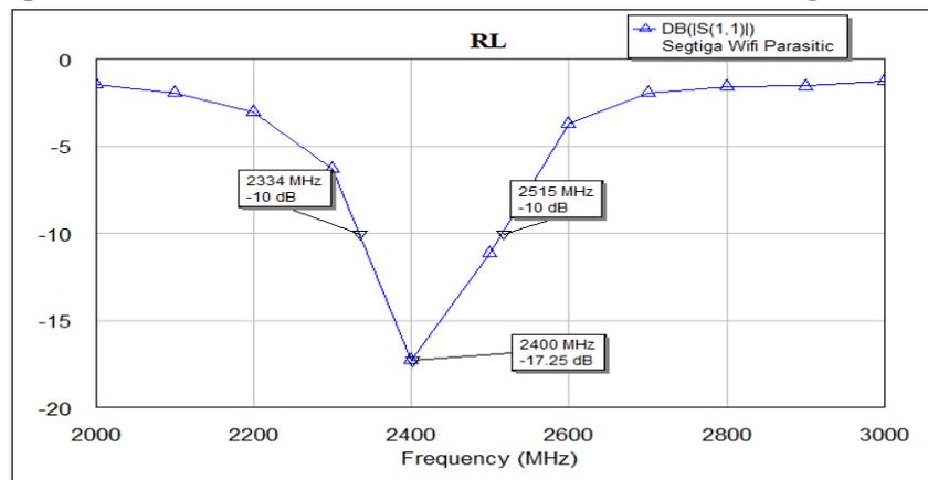
**Gambar 4.7** Nilai *return loss* antenna dengan beban parasitic
