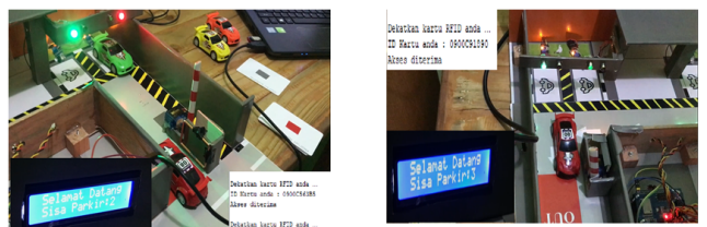
Gambar 9. Percobaan Kedua Menggunakan Kartu RFID Terdaftar
