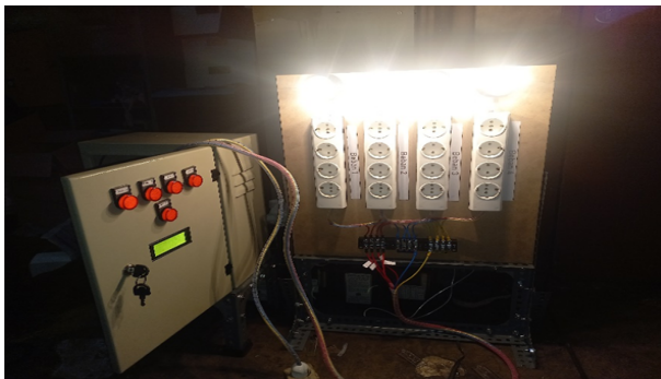
Gambar 10. Prototipe alat monitoring dan pengendali beban listrik
