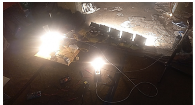
Gambar 11. Pengujian sistem monitoring dengan total beban 5 buah lampu Halogen 500 W.
