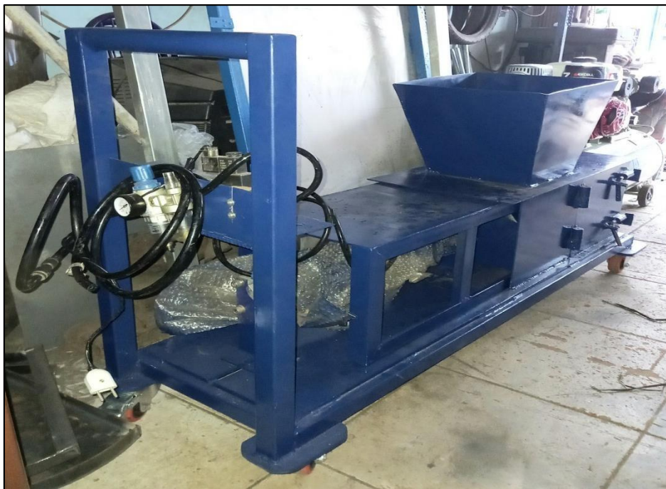
Gambar 8 Mesin press kaleng
