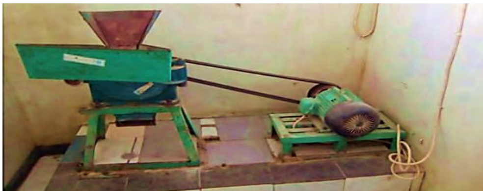
Gambar 6 Mesin Disk Mill Penghalus Chips Mocaf menjadi bubuk/tepung Sumber : Dalam Nurhikmat dan Kurniadi (2013)(Rahmi Lestari Helmi, 2020)
