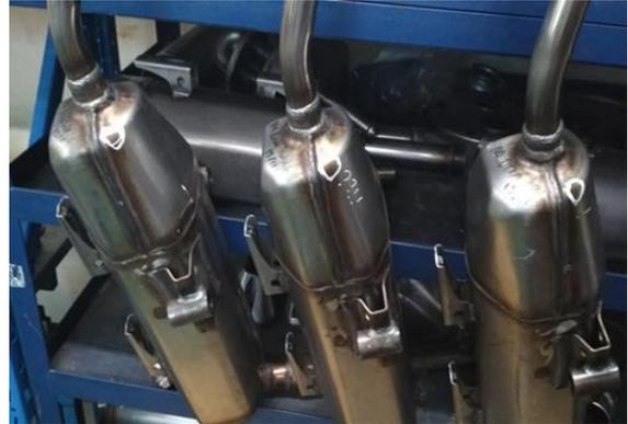
Gambar 4.1 Produk Cap A/B Type A12D1 Knalpot Motor.
