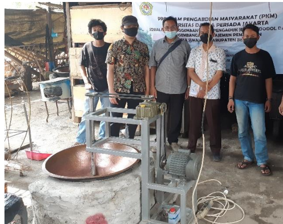
Gambar 5. Mesin Pengaduk Dodol Hasil Rancangan
