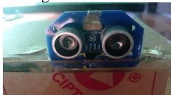
Gambar 18. Sensor Jarak
