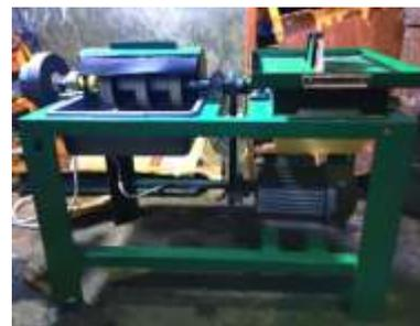
Gambar 4 Mesin Pemotong Penggosok Logam dan Non Logam
