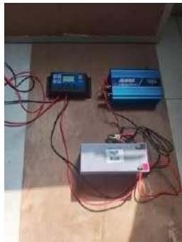
Gambar 14 Arus DC Hasil Energi Sel Surya Diubah Menjadi AC Melalui Inverter
