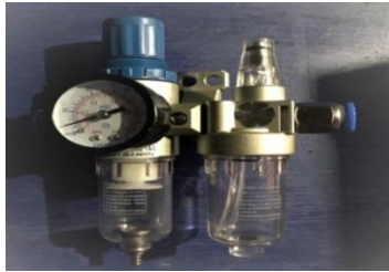
Gambar 2.4.2 Unit pelayanan udara
