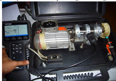
Gambar 3.6. Perangkat uji sebelum dipasang sensor getaran dan shock pulse
