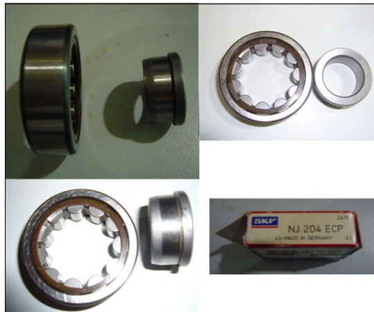
Gambar 4.1. Pengamatan visual kondisi bantalan gelinding baru
