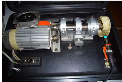
Gambar 3.6. Perangkat uji sebelum dipasang sensor getaran dan shock pulse
