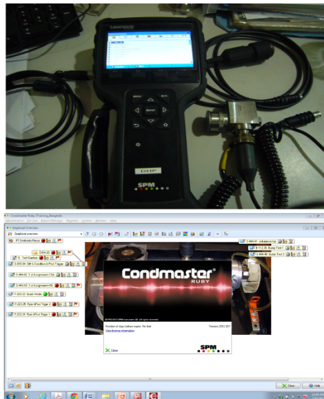
Gambar 3.8. Perangkat akuisi data Leonova Diamond SPM beserta sensor dan perangkat lunak Condmaster Ruby SPM
