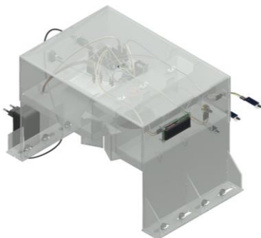
Gambar 3.6 Desain pemotong batang bawang
