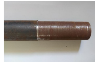
Gambar 4.7 Kondisi Material (Benda Kerja) Setelah Dibubut Dengan Kecepatan Putar 300 Rpm
