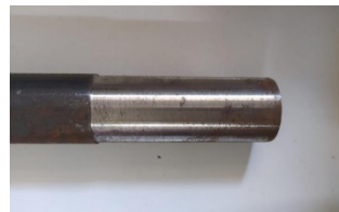
Gambar 4.8 Kondisi Material (Benda Kerja) Setelah Dibubut Dengan Kecepatan Putar 700 Rpm
