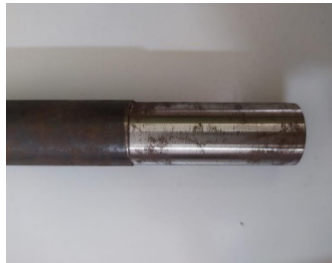
Gambar 4.9 Kondisi Material (Benda Kerja) Setelah Dibubut Dengan Kecepatan Putar 1200 Rpm
