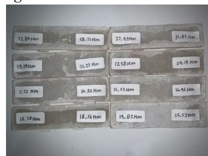
Gambar 3.1 Spesimen uji dengan standar ASTM D5868.
