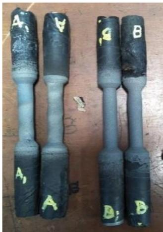
Gambar 4. Spesimen benda kerja uji Tarik
