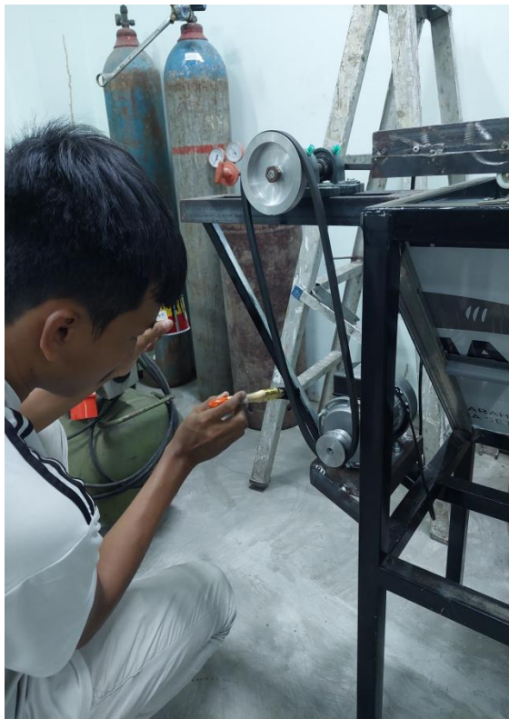
Gambar 9. Proses Pemasangan Belt
