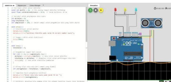
Gambar 3. 2 Simulasi kalibrasi arduino jarak 70 cm selama 1 menit
