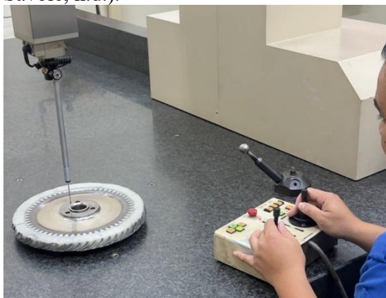
Gambar 2. 2 Proses Pengukuran CMM
