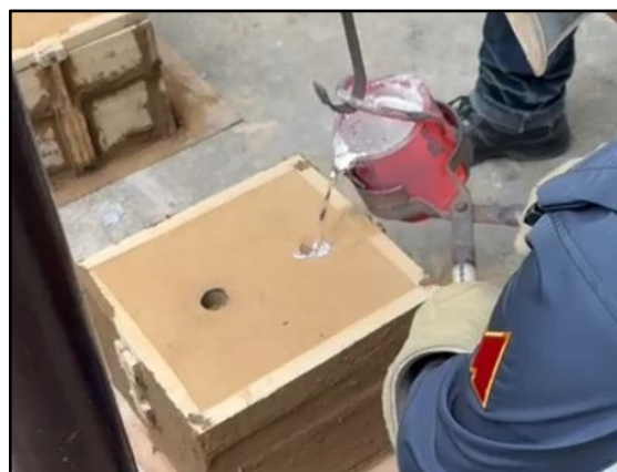
Gambar 2.4 Penuangan Logam Cair
