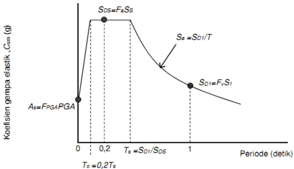
**Gambar 1. Bentuk tipikal respon spektra di permukaan tanah**
