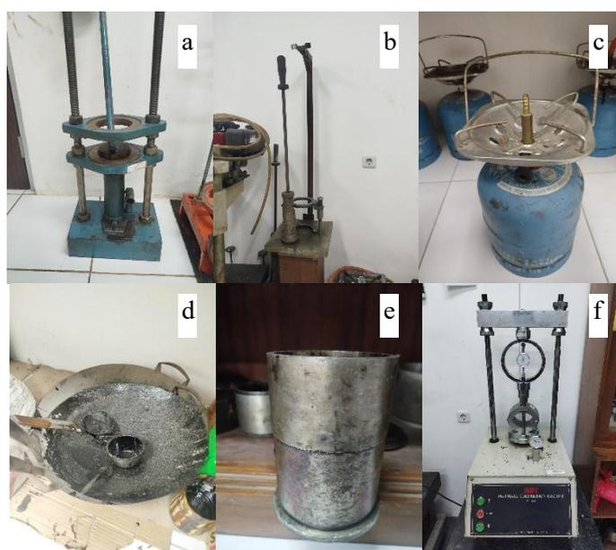
Gambar 2. Persiapan Alat Pembuat Sampel<sup>1</sup> dan Alat Uji Marshall<sup>2</sup>
