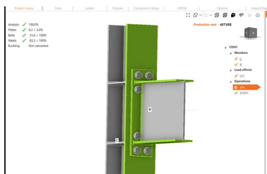
Gambar 7. Analisis Sambungan Menggunakan Software IDEA Statica
