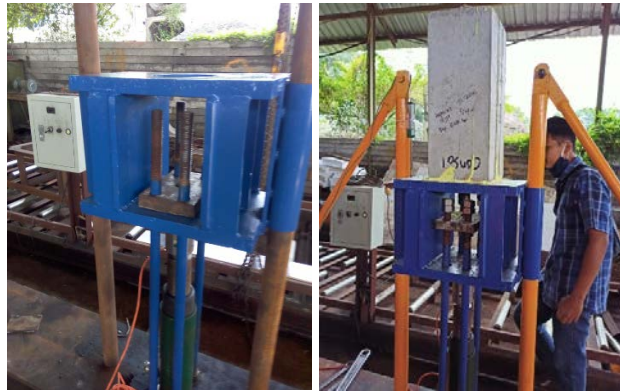
Gambar 2 Uji Pull-Out dan Perletakan Spesimen
